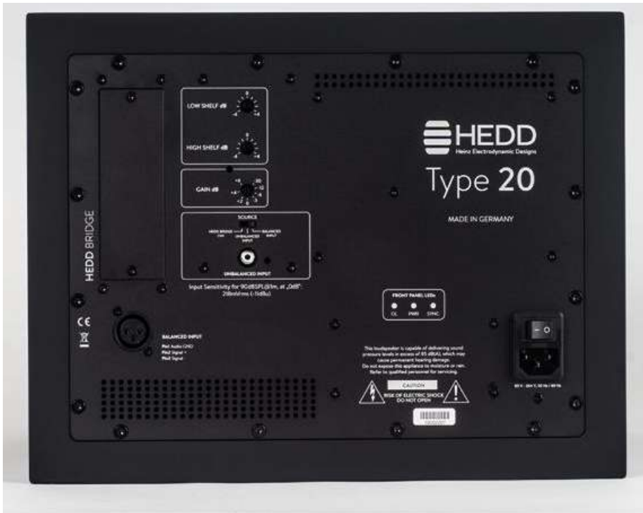
Die Rückseite des Type 20. Neben der XLR- und der Cinchbuchse findet hier sich hinter einer Platte der Steckplatz für die Digitalerweiterung HEDD Bridge.
